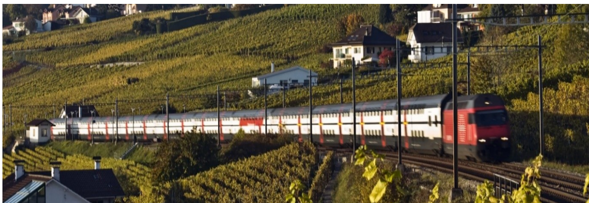
Obrázek č. 9: Elektrická trakce pomáhá ve Švýcarsku zvládat náročné sklonové poměry na tratích Zdroj: https://company.sbb.ch
