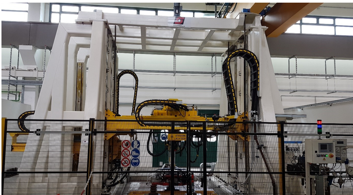
Obrázek č. 5: Zkušebna sběračů proudu (Foto: autor)
