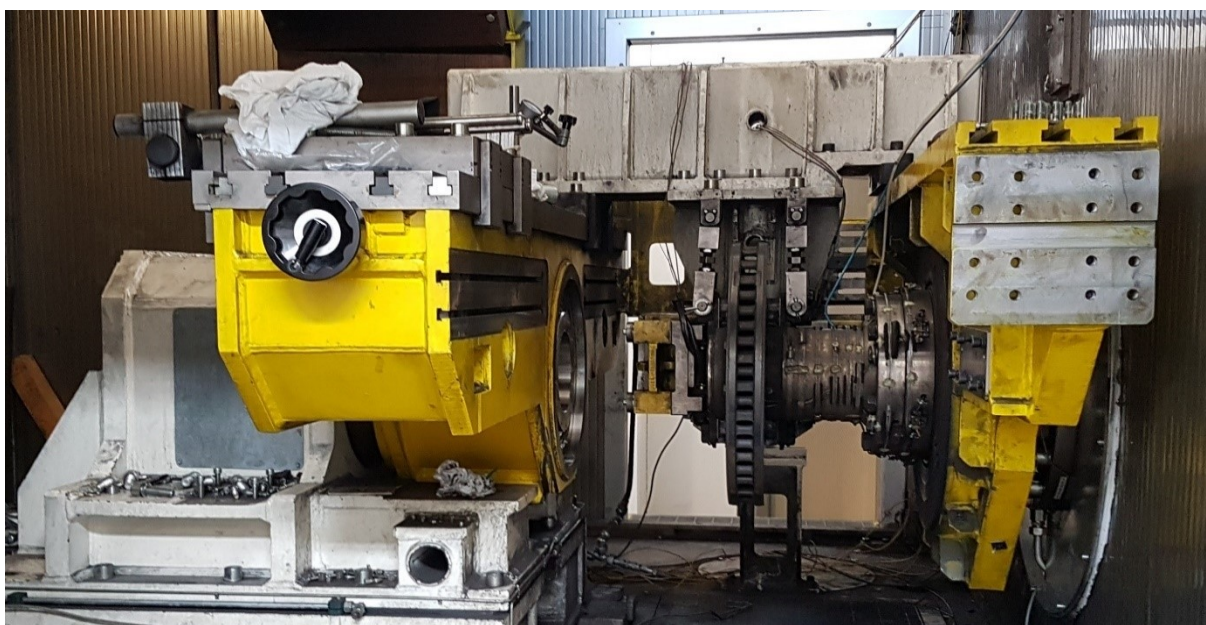
Obrázek č. 3: Dynamický zkušební stav brzdového kotouče (Foto: autor)
