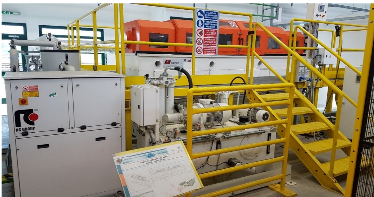
Obrázek č. 4: Dynamický zkušební stav dvojkolí (Foto: autor)
